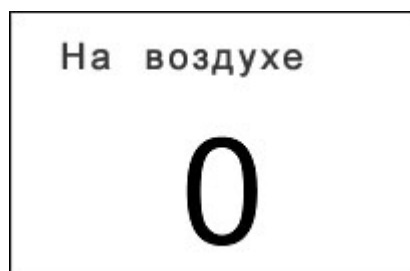
Рис. 2-2 Вид экрана прибора в режиме калибровки собственных шумов преобразователя
